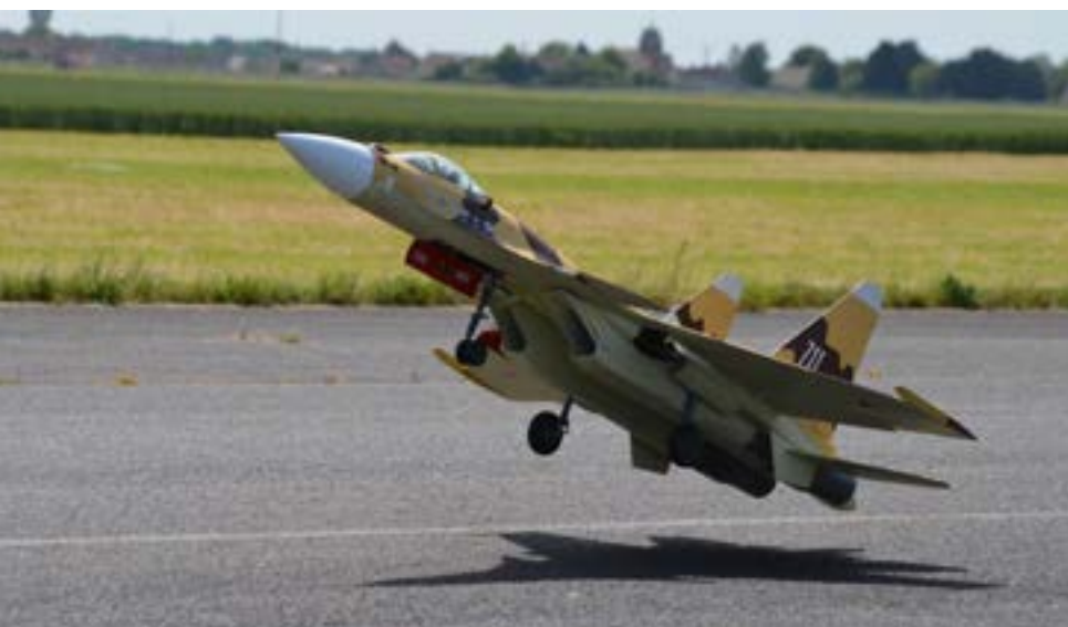
Des vols à couper le souffle pour le SU30 de catégorie B. Piloté par Gilles François. Emmené par deux réacteurs de 16kg dotés de la poussée vectorielle, cet appareil reproduit magnifiquement le cobra et autres vrilles à plat sous le regard ébahi des autres pilotes
